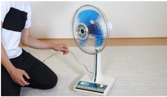
点検の様子（イメージ） 電源コードに触れると急に羽根が回転する／回転が止まる
