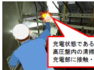
【図2】受電室の感電死傷事故のイメージ* ※実際の事故画像ではありません。
