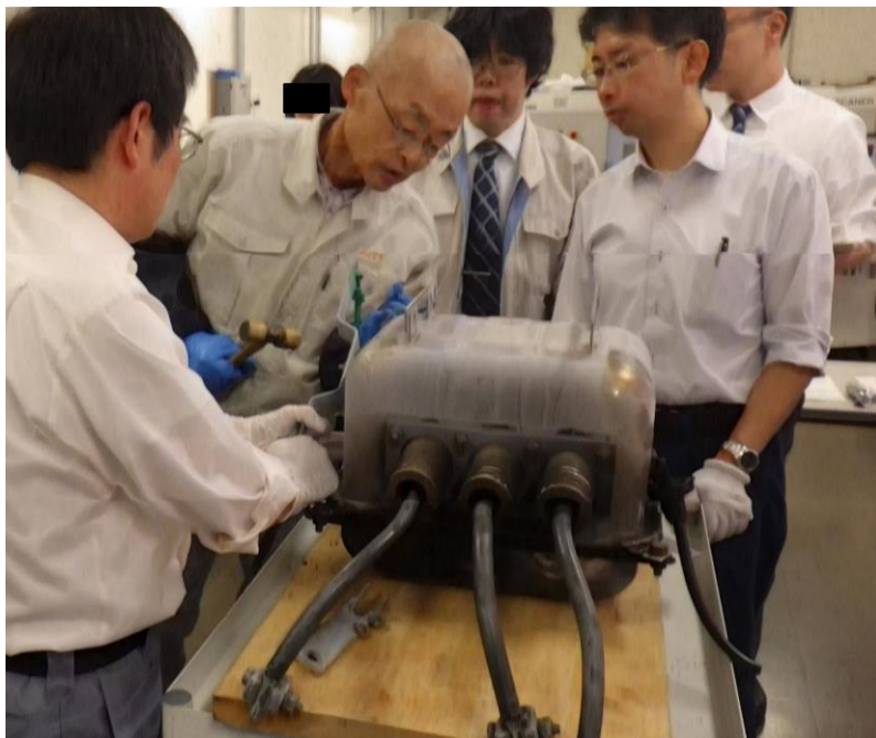
例1 焼損したPASの解体調査
