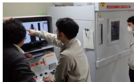
X線透過装置による内部観察
