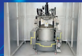
ARC (断熱型暴走反応熱量計) 大型セルやモジュールレベルの試験体の様々な熱力学的データの測定を行うことが可能です。
