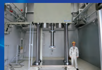
破壊試験 最大荷重300kNでの釘刺し処理、圧壊試験が実施可能です。
