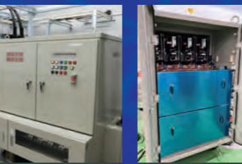
ARC (断熱型暴走反応熱量計) 大型セルやモジュールレベルの試験体の様々な熱力学的データの測定を行うことが可能です。
