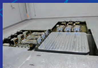
地震波再現試験 東日本大震災、阪神淡路大震災等の地震波を再現可能です。
